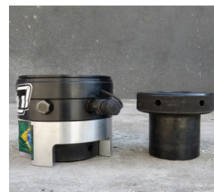
* Tensionador Hidráulico e o Puller
