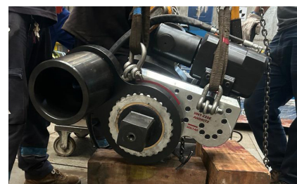
■ Chave de Torque Especial para 280.000Nm - A HNT-220E foi projetada especificamente para a tarefa de soltar porcas e parafusos de turbina hidrelétrica soviética, em operação na Usina Hidrelétrica de Sobradinho, na Bahia.
