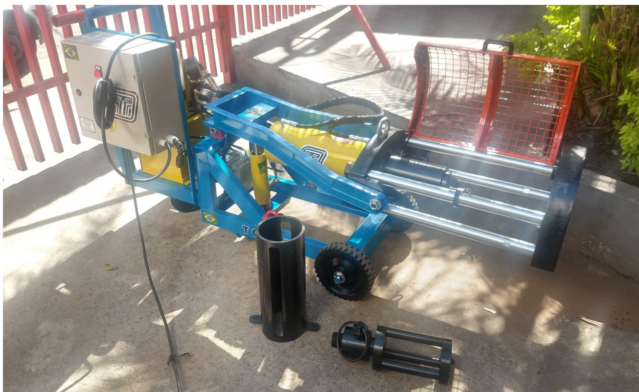
* Sacador de Rolamento Ferroviário Com o Kit de montagem do TERF da TORVEL
