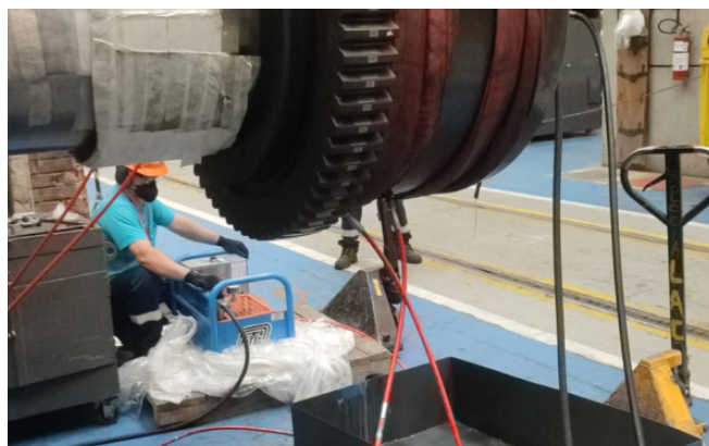
■ Bat-200 - Usada para auxiliar na extração de acoplamento de grande porte.
