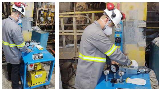
* TBEMC-30420C com válvula controladora de pressão no avanço e no retorno para até 2 cilindros
