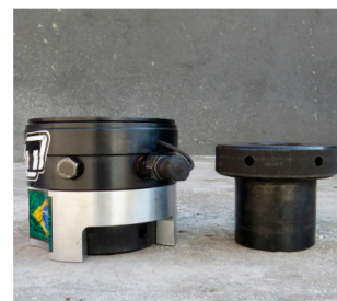
* Tensionador Hidráulico e o Puller
