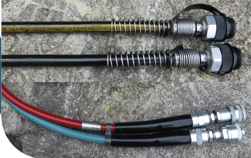
■ Padrão de mangueira montada pela Torvel que seguem com seus produtos do modelo THC série 9 e MMT série 15.
